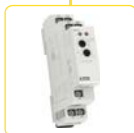
PRI-51 cu transformator încorporat, 5 domenii (1/2/5/8/16 A), domeniul de 5A poate fi utilizat pentru transformatoar de curent (X/5), Tensiunea de alimentare și ieșirea, ca la PRI-32, deosebire este precizia mai mare PRI-32: monitorizează în direct.
