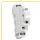
PRI-32 prin transformator (cablul trebuie tras prin dispozitiv, separat galvanic, fara pierderi de temperatură), curentul monitorizat reglabil între 1-20 A. Tensiunea de alimentare: AC 24-240 V, sau DC 24 V, ieșiri 1x 8 A.
